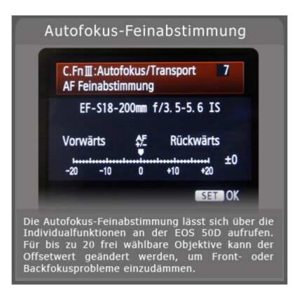
Über diesen Menüpunkt können global bzw. individuell bis zu 20 Objektive bei Front- oder Backfokus-Problemen getunt werden. D.h. sobald konstante Fokussierprobleme auftreten, bei denen die Scharfstellebene regelmässig vor bzw. hinter dem Motiv liegt, kann der Offsetwert in der EOS 50D angepasst werden. Wie sich dies in der Praxis an Zoomobjektiven mit verschiedenen Brennweiten und daher auch theoretisch unterschiedlichen Fokussierfehlern zeigt, wird noch zu untersuchen sein.
