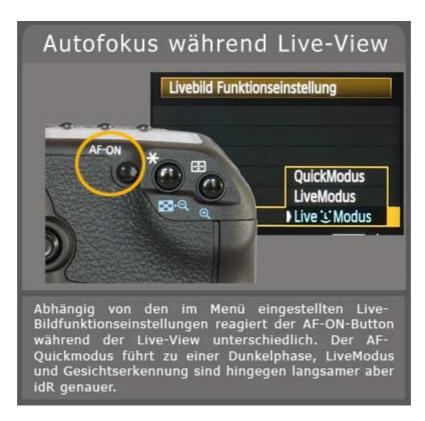
Die Scharfstellung brauchte bei unseren Messungen zwischen 2 - 6 Sekunden. Bei erneutem Fokussieren ist zudem mit einer ähnlichen, idR minimal verkürzten Zeit zu rechnen, da der Live-AF das Fokussier-Procedere komplett neu durchführt (kein Memory). Bei geduldigen Motiven kann der User allerdings auch die 10x-Lupe nutzen und manuell exakt fokussieren, muss dann jedoch die zweite Hand für den Einstellring am Objektiv einsetzen.
