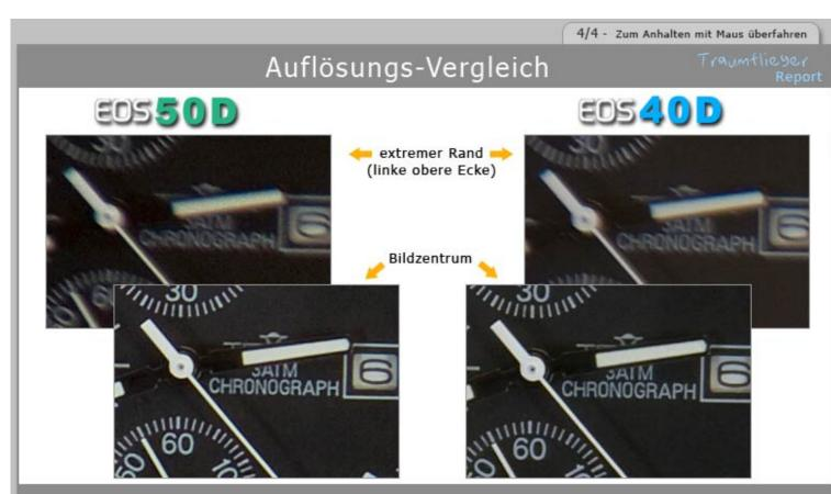
Hier wurden die 100%-Ausschnitte über Distanzänderung angeglichen (EOS 50D weiter vom Motiv entfernt). Die Auflösung ist etwa vergleichbar mit minimalen Vorteilen für die 40D.
